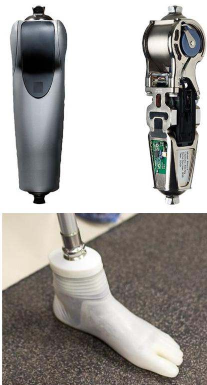
Объединение электронного коленного модуля и электронной стопы в одну систему представляет собой полностью бионическую систему управления протезом.
