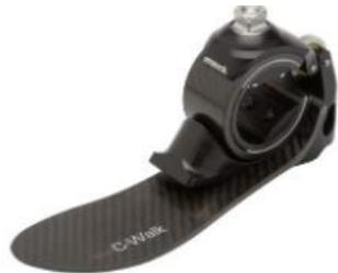
Карбоновые стопы с вертикальными амортизаторами. В конструкции некоторых карбоновых стоп предусмотрены вертикальные амортизаторы, направленных на снижение вертикальных усилий и крутящих нагрузок, что позволяет ощутимо разгрузить кулью пользователя.
